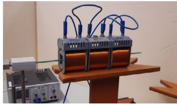
Abb. 9: Messaufbau zur Bestimmung der magnetischen Flussdichte einer kurzen bzw. einer aus kurzen Spulen gebildete „langgestreckte“ Spule entlang der Spulenachse.
