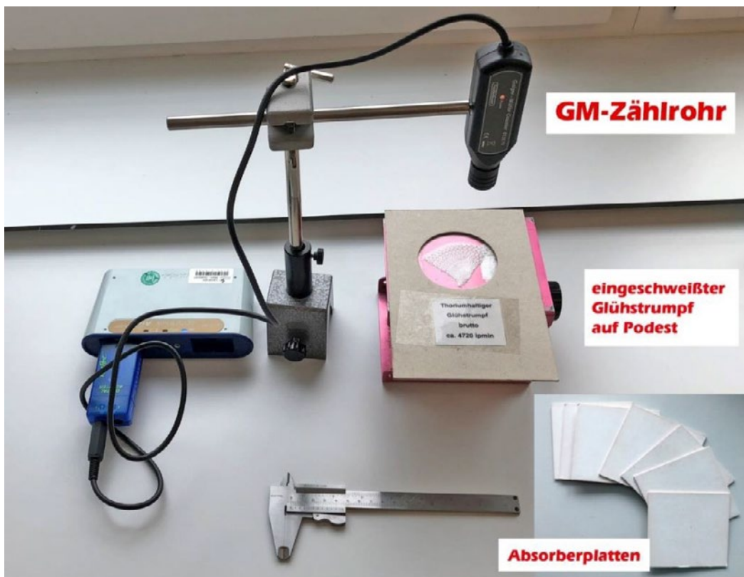
Abb. 1: Einfacher Aufbau zur Untersuchung von Abstands- und Absorptionsgesetz.
