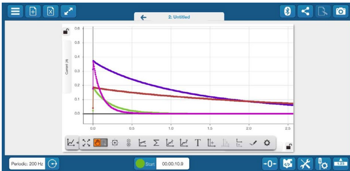
Abb. 8: Darstellung der Ladestromstärke für Kombinationen zweier Widerstände und zweier Kondensatoren, diesmal mit den PASCO-Sensoren aufgenommen. Der Schnittpunkt mit der Hochwertachse liegt laut Theorie bei I_0 = \frac{|U_0|}{R} und ist auch hier bei jeweils zwei Messungen gleich.
