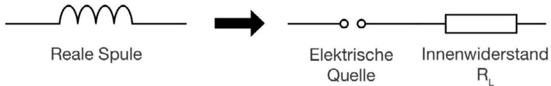
Abb. 3: Eine reale Spule fassen wir als Reihenschaltung aus elektrischer Quelle und Innenwiderstand auf.
