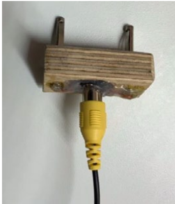
Abb. 3: Adapter zum Anschließen des Audioausgangs des Tablets an das Steckbrett
