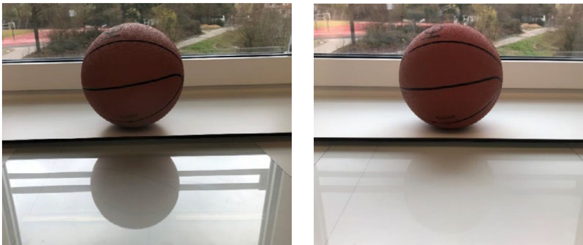
Abb. 3: Freihandexperiment zum Brewster-Gesetz. Bei einem Blickwinkel von ca. 30^\circ zur Ebene der Glasscheibe verschwindet die Reflexion in der Glasscheibe fast vollständig, wenn der Blick durch einen geeignet orientierten Polarisationsfilter erfolgt. Das Bild zeigt links den Blick ohne und rechts durch einen Polarisationsfilter mit senkrechter Polarisationsrichtung.
