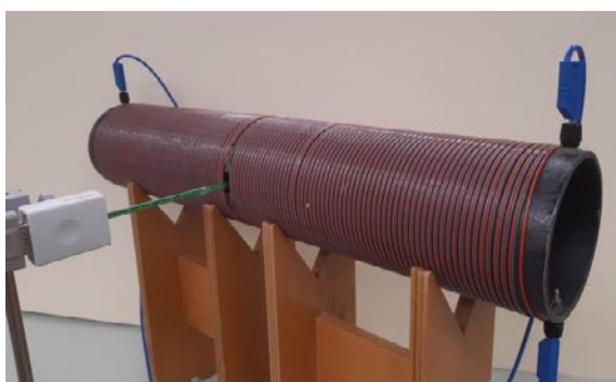
Abb. 3: Messung der magnetischen Flussdichte in der Spulenmitte quer zur Spulenachse.
