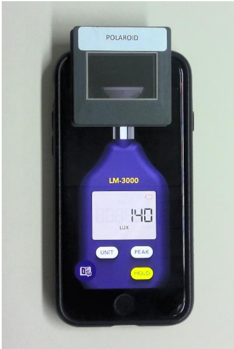
Abb. 18: Smartphone mit entsprechender App als Helligkeitssensor.
