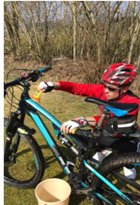
Hartnäckigen Dreck mit Reiniger einsprühen und einwirken lassen; anschließend nochmals mit Wasser abspülen. Mit einem Lappen Fahrrad abtrocknen.
