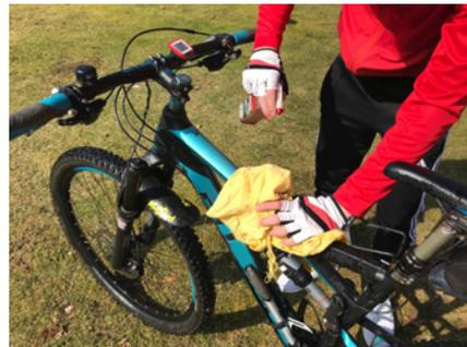
Kette mit Bürste und Lappen reinigen.
